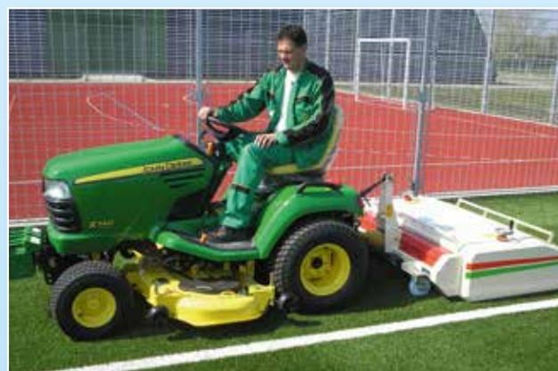
den Feinstaub auszufiltern. Weiterhin sollen die abgeknickten Rasenfasern wieder aufgerichtet und das Füllmaterial zur Stabilisierung des Rasenflors wieder eingebracht werden. Ansonsten soll die Fläche nach der Maßnahme optisch einen gleichmäßigen Eindruck hinterlassen.
