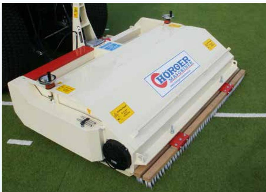
schmutz wird entfernt, Feinanteile welche für die Verhärtung verantwortlich sind werden ausgefiltert.
