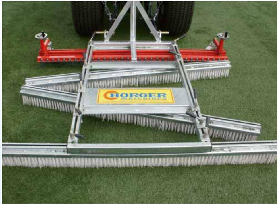
1. Einer Stahlfederrecheneinheit zur Auflockerung.
